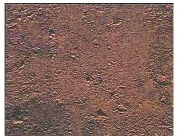
Condition D Blasted to Sa 1
