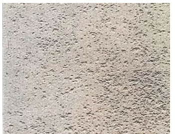
Condition D Blasted to Sa 2,5
