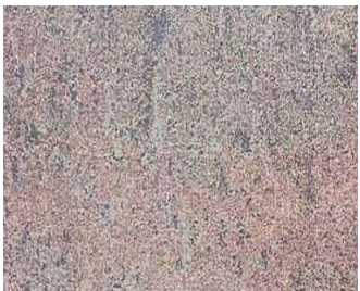
Condition B Blasted to Sa 2
