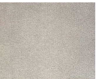
Condition A Blasted to Sa 3
