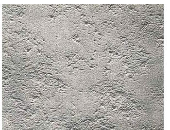
Condition D Blasted to Sa 3
