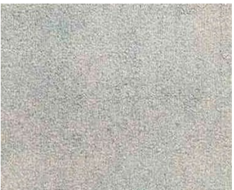
Condition A Blasted to Sa 2
