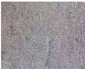
Condition A Blasted to Sa 1
