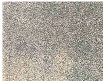
Condition D Blasted to Sa 2
